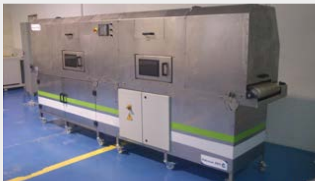
Figura 1. Horno de microondas de 12 kW de potencia total
