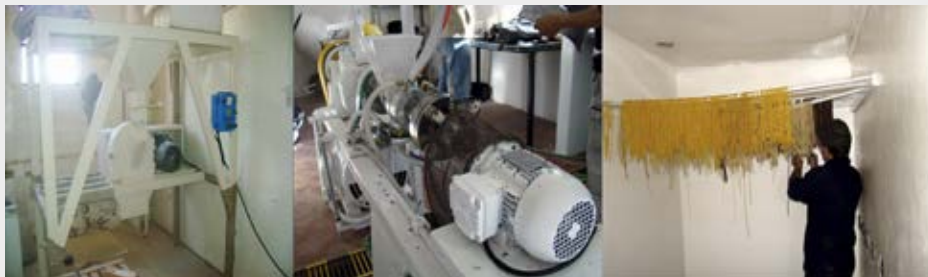
Figura 5. Línea de producción de fideos libres de gluten (molino, extrusor, secadero)
